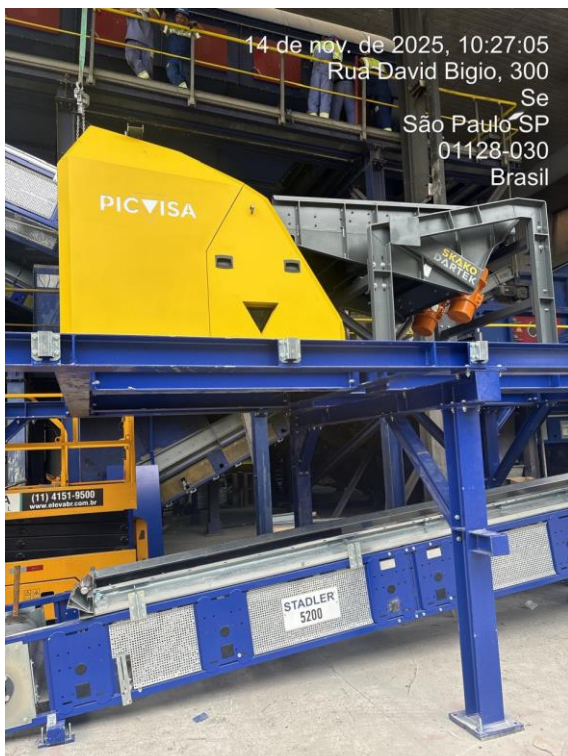
Instalação do Seletor Ótico de vidros e de peneira mecânica em novembro de 2025.
